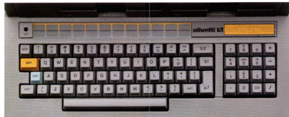
Figura 14.17. Tastiera QZERTY dell'elaboratore Olivetti M20 BC, anno 1982, da una foto di Davide Bucci.
