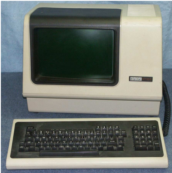
Figura 14.15. Il terminale video più comune, DEC VT100 del 1978, aderente allo standard ANSI X3.64, ovvero ECMA-48, ovvero ISO/IEC 6429. Questa foto è di Dave Dunfield, tratta da Daves Old Computers http://www.classiccmp.org/dunfield/tty/ .
